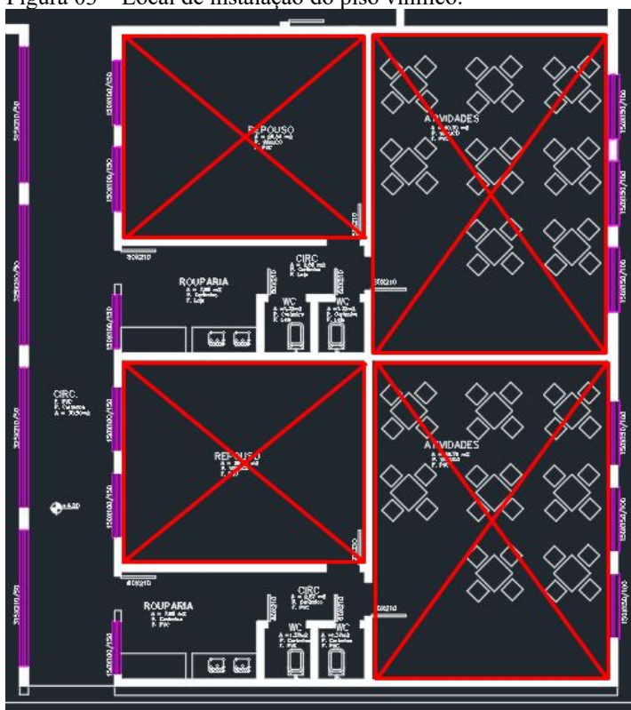
Figura 03 – Local de instalação do piso vinílico.
